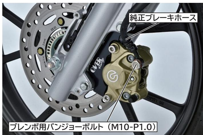
※純正のブレーキホースで装着する場合、バンジョー部分を元の向きとは反対にすると取付ができます。
